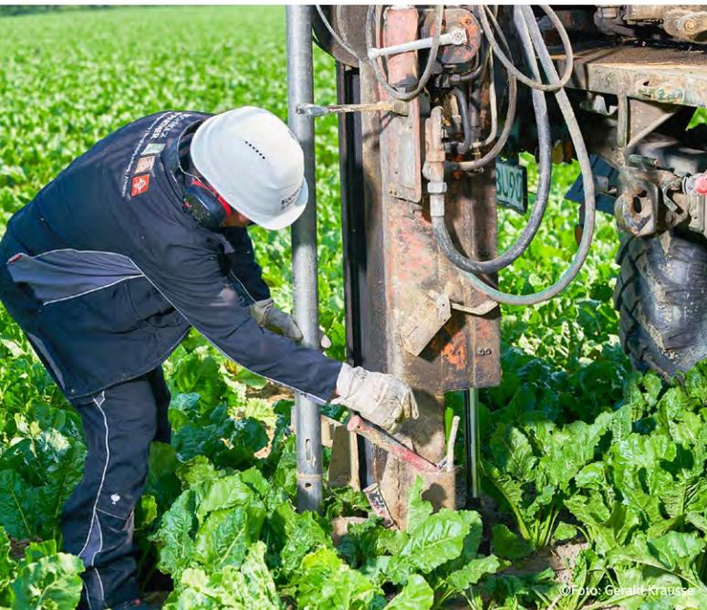
Mit einem Kernbohrgerät werden Bodenproben entnommen.
