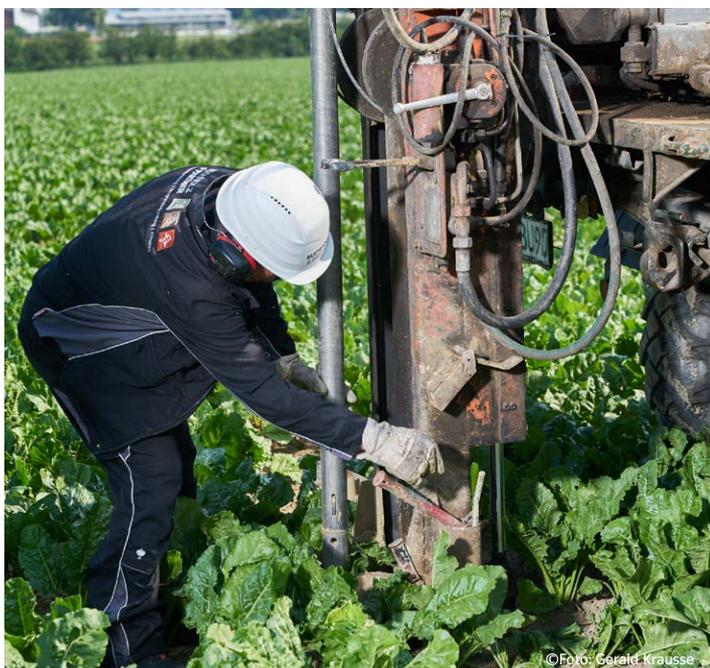
Kernbohrgerät zur Entnahme von Bodenproben
