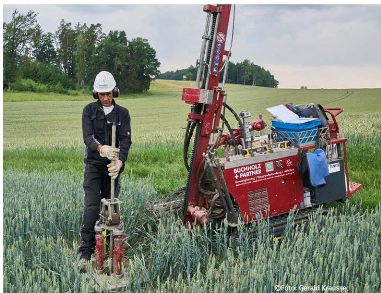
Bohrgerät für Raumsondierungen
