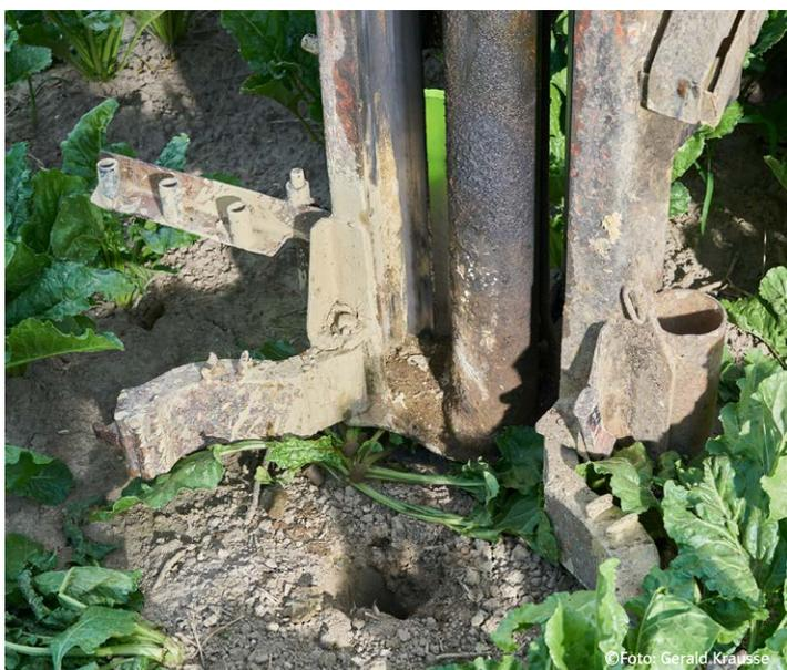
Der Bohrkern für die Entnahme der Bodenproben hat einen Durchmesser von wenigen Zentimetern. Nach Entnahme der Proben wird das Bohrloch wiederverfüllt.
